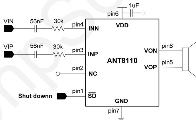
图4. ANT8110 差分输入工作模式电路图
