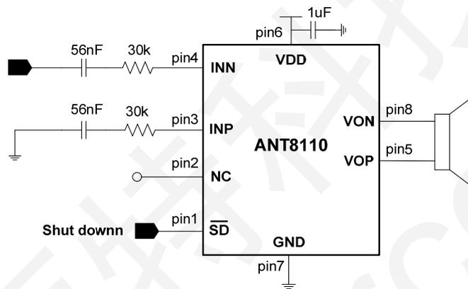
图3. ANT8110 单端输入工作模式电路图
