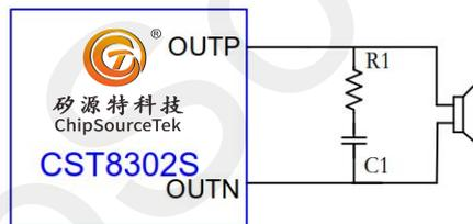
**EMI 处理:** 对于输出走线较长或靠近敏感器件时, 建议加上磁珠和电容, 能有效减小EMI。器件靠近芯片放置
